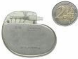
Afbeelding 1: De neurostimulator is ongeveer twee keer zo groot als een 2 euro munt.
