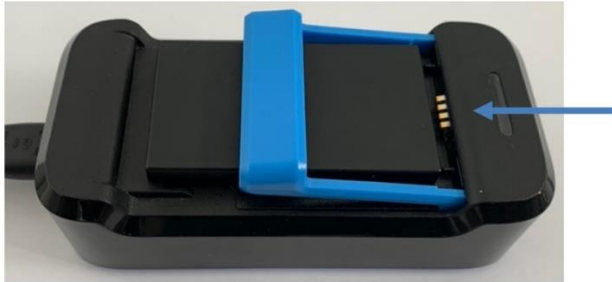
Afbeelding 5: Onjuist geplaatste accu.
